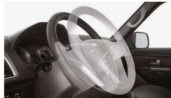
В UAZ Patriot регулировка рулевого колеса осуществляется как по углу наклона, так и по вылету
