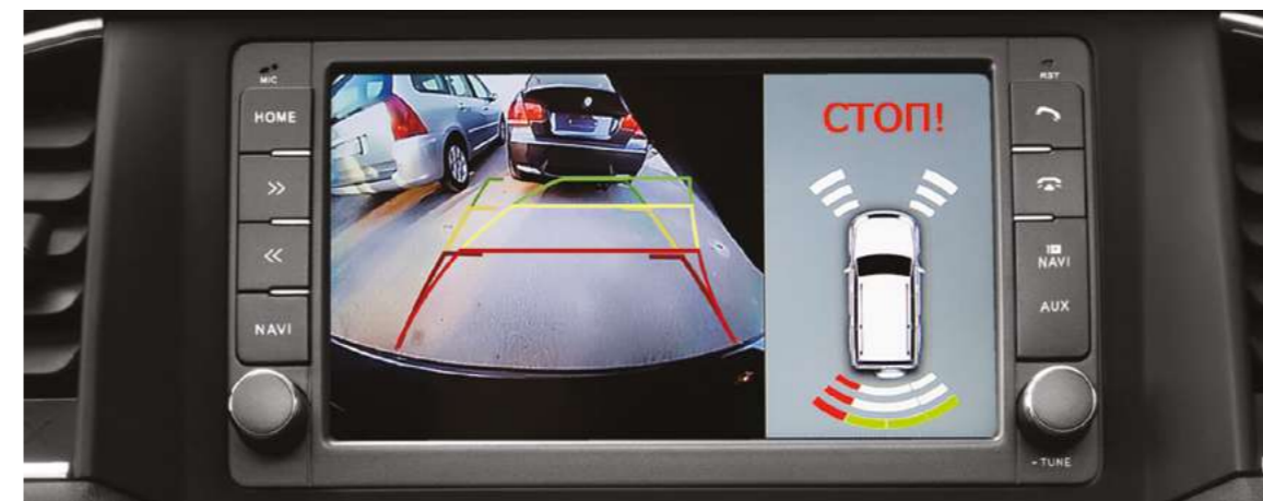
При движении задним ходом на цветной экран выводится изображение с камеры заднего вида с динамическими линиями и работа задних и передних датчиков парковки
