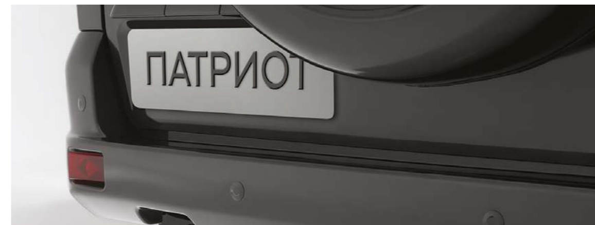
Задние датчики парковки на бампере и камера заднего вида в ручке задней двери
